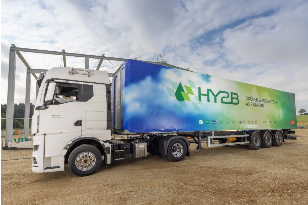
Abbildung: Wasserstoff Transporttrailer für 1,25 Tonnen Grünen Wasserstoff, wie er ab September die ersten Bustankstellen in Brunnthal und Glonn in den Landkreisen München und Ebersberg mit grünem Wasserstoff versorgen soll
